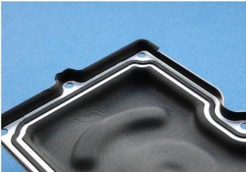
Les couches d'oxyde et les résidus de production peuvent être éliminés rapidement et complètement par la seule puissance du rayonnement laser. Les paramètres sont ajustés avec précision en fonction de l'application afin de garantir un résultat optimal ainsi que l'intégrité du moule.
