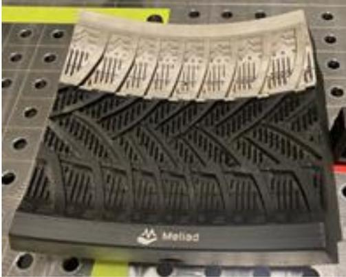
Le nettoyage des moules à l'aide de notre procédé laser constitue une alternative économique et écologique aux méthodes de nettoyage conventionnelles. Même les résidus persistants peuvent être éliminés avec précision sans laisser d'abrasifs ni endommager les surfaces sensibles des moules. La durée de vie des moules et des outils augmente considérablement.
