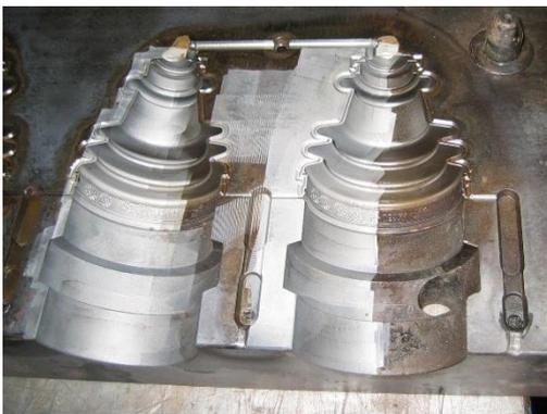
Avec des cadences d'environ 22m<sup>2</sup> par heure, les temps de nettoyage sont minimisés limitant ainsi les arrêts de production. Les systèmes laser peuvent facilement être intégrés sur ligne ou utilisés manuellement. Même les moules chauds peuvent être nettoyés directement sur presse.
