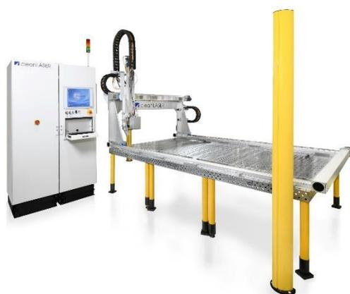
Machine multiaxes avec posages mécaniques
