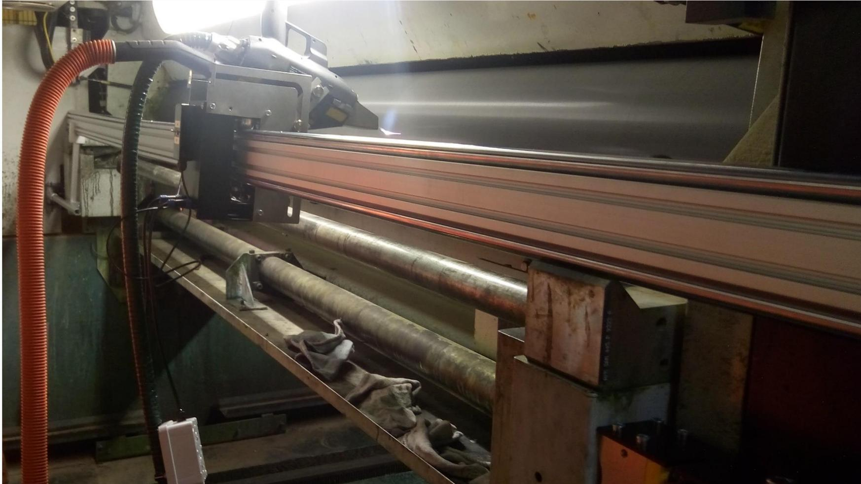
Système d'aspiration intégré simultané au décapage laser qui permet de ne pas générer de déchet extérieur.
