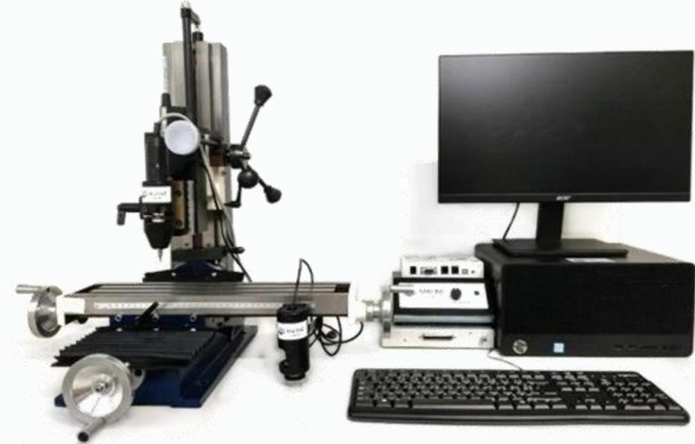
Equipement **Meliad** de mesure par perçage incrémental (**Mirastar**)
