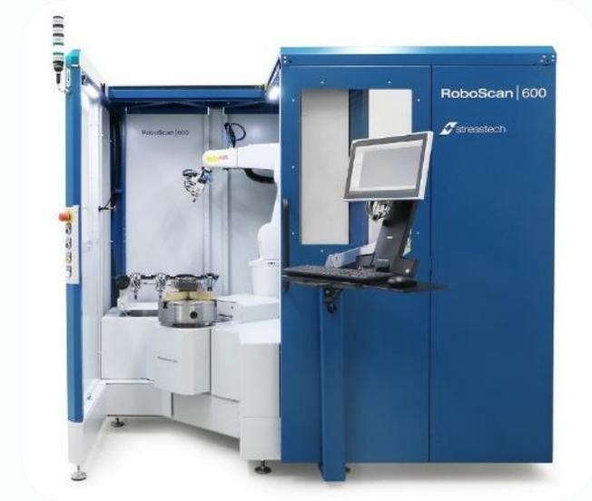
Détection des Brûlures de rectification par bruit Barkhausen
