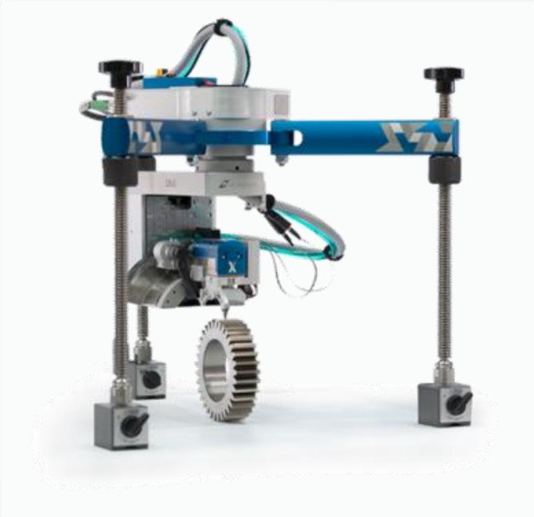
Appareils Stresstech de mesure par diffraction des rayons X
